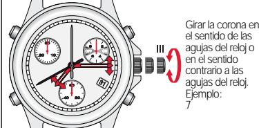
Sincronización de la hora del reloj interno con la hora analógica y cambio de horario invierno/verano.
